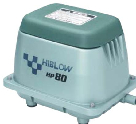
Механика работы компрессора основана на движении в переменном электромагнитном поле магнитного поршня, приводящего в действие резиновые мембраны. Эта технология имеет множество преимуществ:
