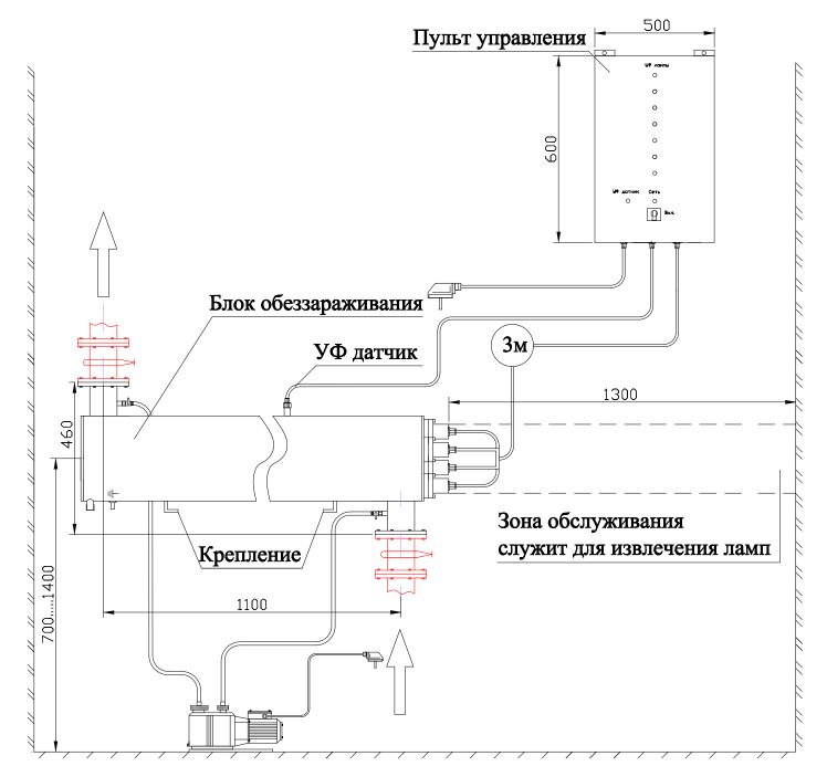
Примечание: монтаж установки к стене или полу производиться при помощи крепежных уголков находящихся на блоке обеззараживания
