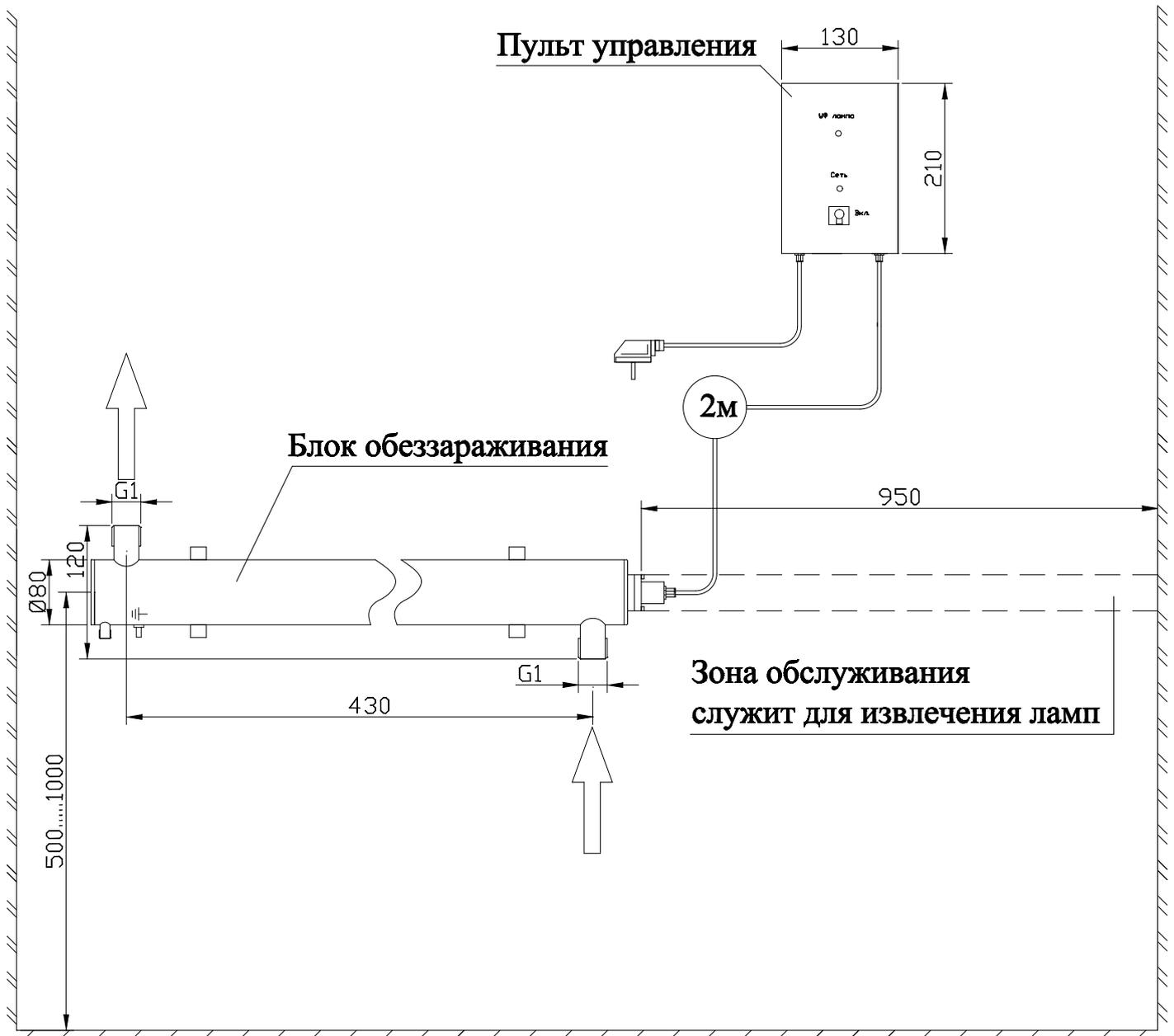
**Примечание: монтаж установки к стене производится при помощи двух хомутов Ø80 мм.**
